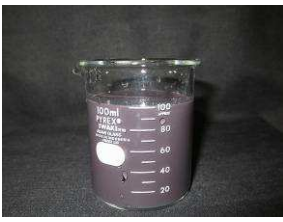
A工場インキ含有排水原水
