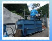
トンネルの試験掘りから排出 されるベントナイトと油含有 の排水処理。
