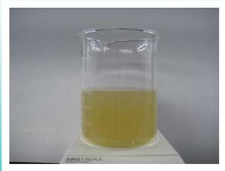
排水の濃度により添加量は異なりますが、目安として0.05%~0.1%投入し攪拌します。
