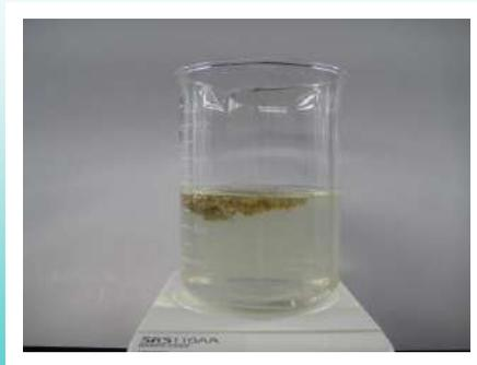
素早く凝集し、強靱で粗大なフロックを形成して、静止後スラッジは浮上します。
