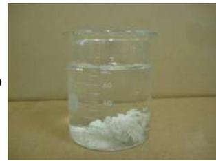
少量ですばやく凝集し、強靱で粗大なフロックを形成します。フロックが大きくなる事で、汚泥の沈降速度が早くなります。
